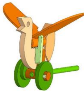
Рис.2 – Модель игрушки «Птица» с кулачковым механизмом
