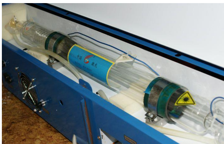
Рис.2 Трубка лазерно-гравировальной машины, генерирующая CO2.
