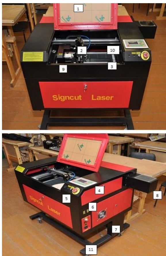
Рис.4 Устройство лазерно-гравировального станка (а и б)
