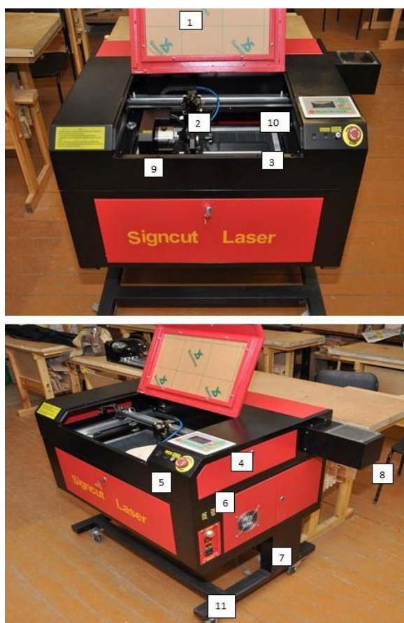
Рис.4 Устройство лазерно-гравировального станка (а и б)
