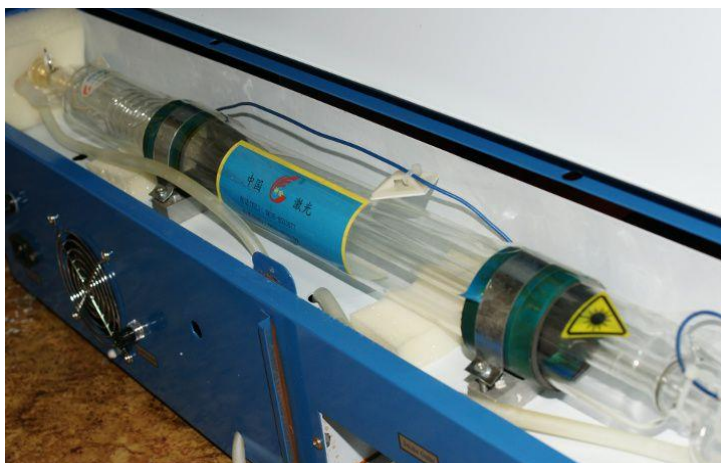
Рис.2 Трубка лазерно-гравировальной машины, генерирующая CO2.
