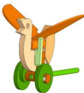
Рис.2 – Модель игрушки «Птица» с кулачковым механизмом
