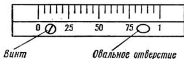
Рис. 12 - Перемещение линейки нониуса
